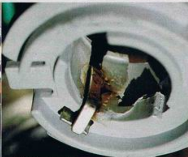
Die Lampenfassung des Scheinwerfers bekam angesichts der enormen 35 Watt Lichtleistung zuerst Hitzewallungen, fiel dann total aus
